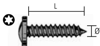
Vite autofilettante flangiata testa cilindrica tonda impronta Tx zincata nera
